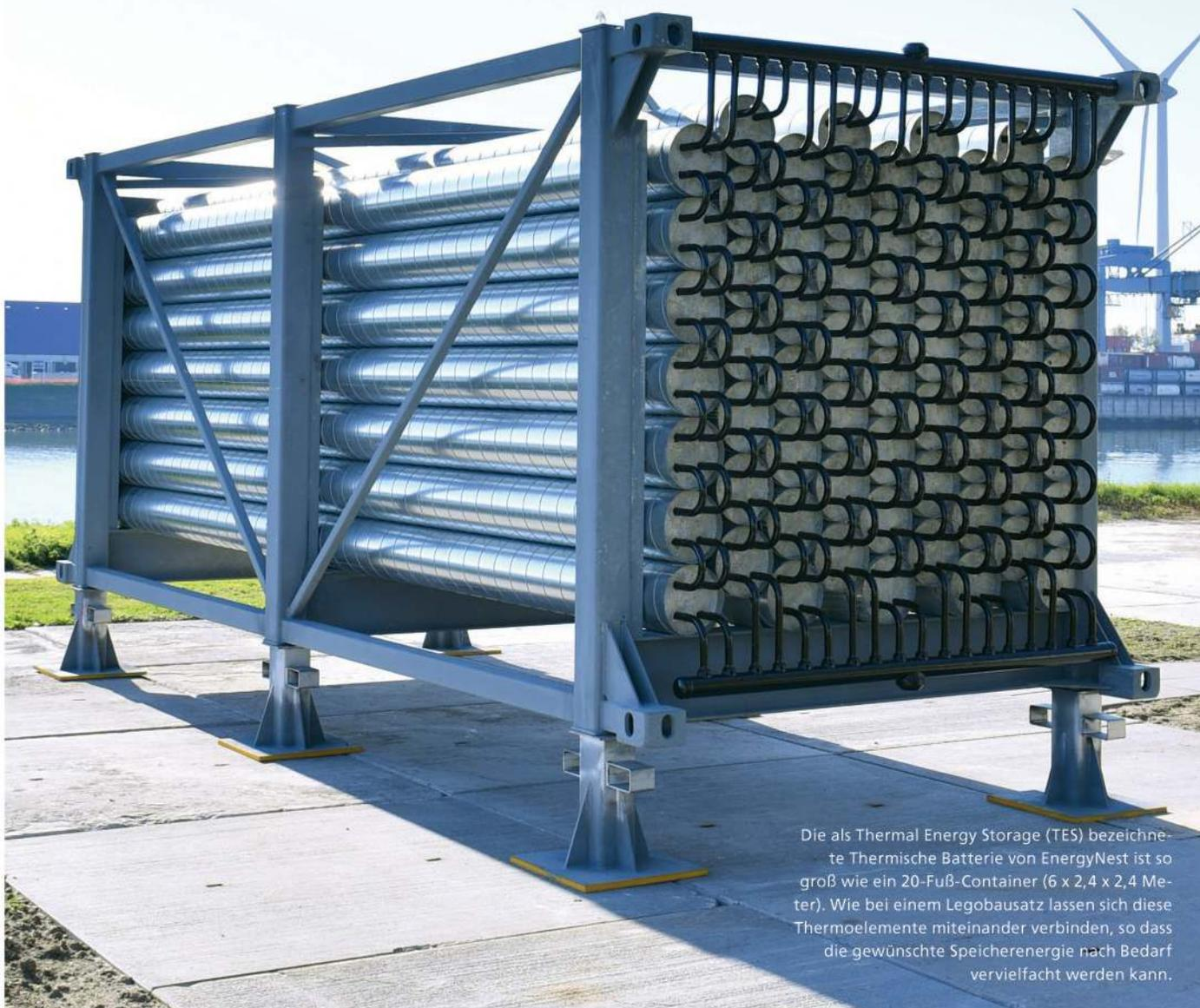
Die als Thermal Energy Storage (TES) bezeichnete Thermische Batterie von EnergyNest ist so groß wie ein 20-Fuß-Container (6 x 2,4 x 2,4 Meter). Wie bei einem Legobausatz lassen sich diese Thermolemente miteinander verbinden, so dass die gewünschte Speicherenergie nach Bedarf vervielfacht werden kann.
